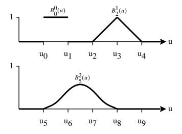
Eine B-Spline Kurve mit Basen des Grades 1 besteht aus dem Streckenzug der Kontrollpunkte.
