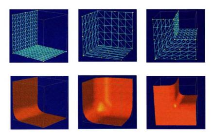
Durch die Möglichkeit, lineare (und auch nicht lineare) Zwänge an die Kurve vorgeben zu können, lassen sich mehrere Flächen-Patches recht einfach zusammenfügen. Durch die Vorgaben der Gewichte und des Kontrollnetzes, der Dynamik und der Constraints, werden Stetigkeitsbedingungen automatisch erfüllt. Das Bild zeigt wunderschöne Rundungen, wie sie jederman gerne sieht.
