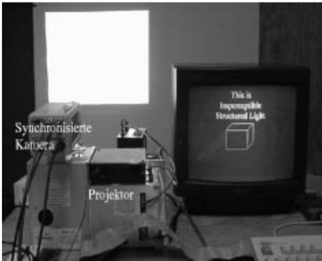
Abbildung 5: Der Text kann nur mit einer synchronisierten Kamera gesehen werden.
