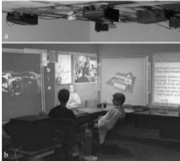
Abbildung 9: a) Kameras und Projektoren sind an der Decke installiert b) Schaumstoffplatten, die als SID benutzt werden
