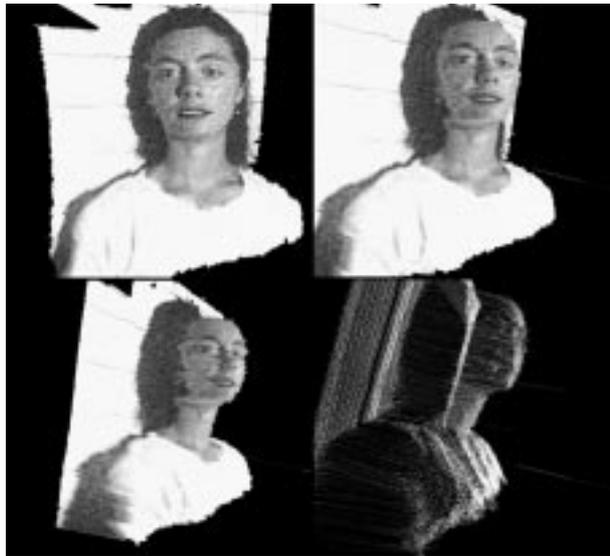
Abbildung 2: Einige Resultate von Tiefenextraktion mittels binär kodiertem, strukturierten Licht
